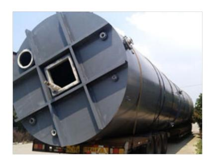
迄今为止F4粉末模压法衬里技术是F4衬里较新的第五代产品,可在更高正负压、高温、强腐蚀的条件下使用,在温度200℃和真空为0.096MPa以下,骤冷骤热或冷热交替操作,不会使聚四氟乙烯基层脱落、起鼓吸瘪、膨胀变形,从而起到了钢氟等体化。钢衬聚四氟乙烯(PTFE)的制作工艺推(挤)压衬里直管制造工艺:首先采用进口PTFE粉末,推(挤)压成管子,然后将它强行拉入无缝钢管(衬管外径略大于钢管内径15-2mm)□形成无间隙紧衬。为了消除压力,将它放在炉中,加温至1800C进行恒温处理,使之适应在180℃以下的温度中使用。广西技术钢衬PTFE无锡钢衬PTFE的价格是多少?
